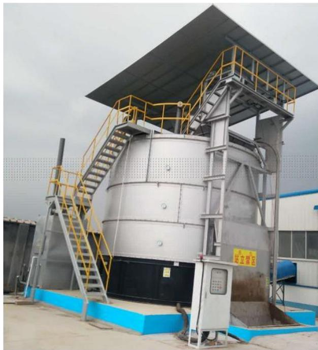
图 6.2-2 立式发酵罐（全密闭）
